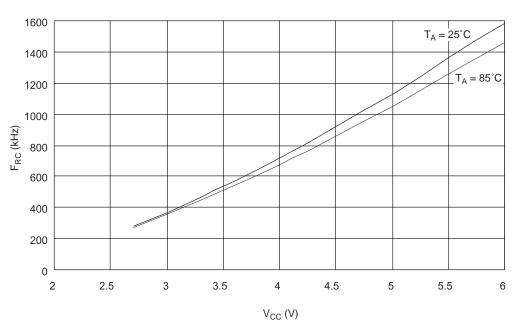
WATCHDOG OSCILLATOR FREQUENCY vs. V<sub>CC</sub>
